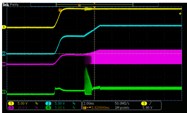
Figure 24. Power up ( I_{LOAD}=1.6\text{ A} ) CH1: VIN; CH2: VO; CH3: SW; CH4: IL
